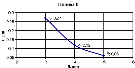
Фиг. 11. Изменение на преместванията u за Планка II, в зависимост от дебелината \delta на листовия материал.
