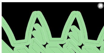
Фиг. 3 Формиране на единичен слой от прототип на зъбно колело с модул m=1 и брой зъби z=52
