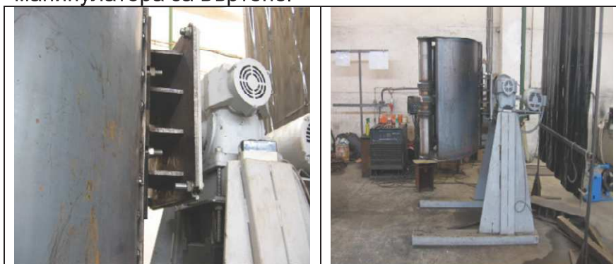
Табл. 3. Заварявана на грайфер SL500G с манипулатора за въртене.
