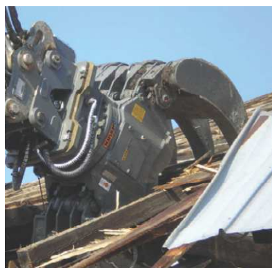
Фиг. 2. Грайфер за разрушаване – Kinshofer (Германия) [2].
