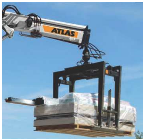
Фиг. 1. Хващач за товарно-разтоварни дейности – Atlas (Германия) [1].
