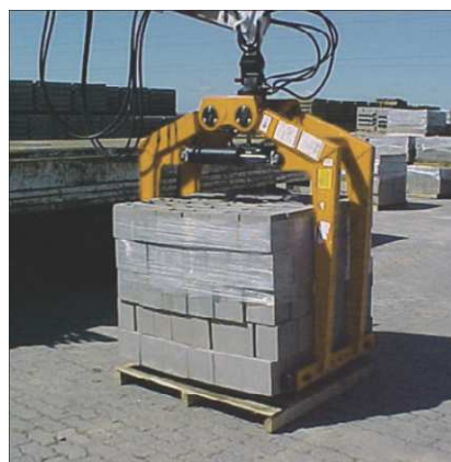
Фиг. 2. Хващач за товарно-разтоварни дейности – Kinshofer (Германия) [2].
